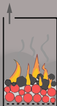
ŚREDNIA Spalanie następuje od dołu, opał dorzucany jest małymi porcjami
